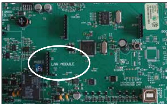
Inserire il modulo AmicaWEB Plug & Play opzionale, sul connettore LAN MODULE evidenziato in figura.
