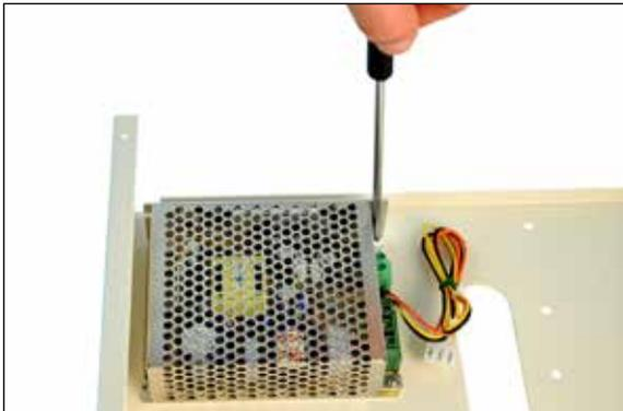
b. Usando la vite fornita con l'alimentatore switching, avvitare la scheda alimentatore sul foro presente nell'angolo superiore sinistro del contenitore come in figura.
