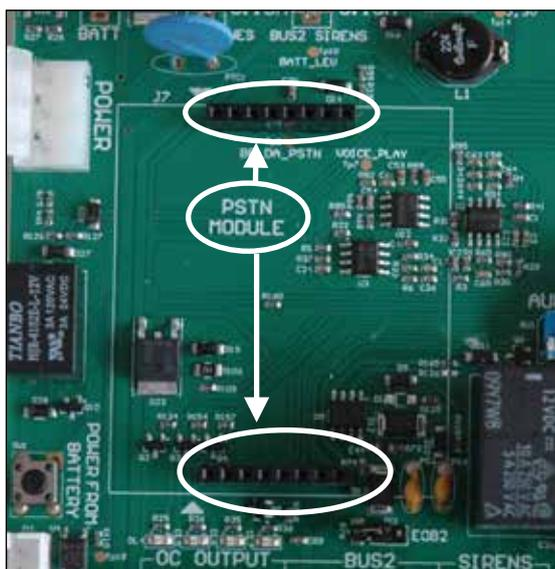
Inserire il modulo PSTN opzionale sul connettore PSTN MODULE, facendo corrispondere i triangolini disegnati sulla scheda centrale ed evidenziati in figura con quelli indicati sul modulo.
