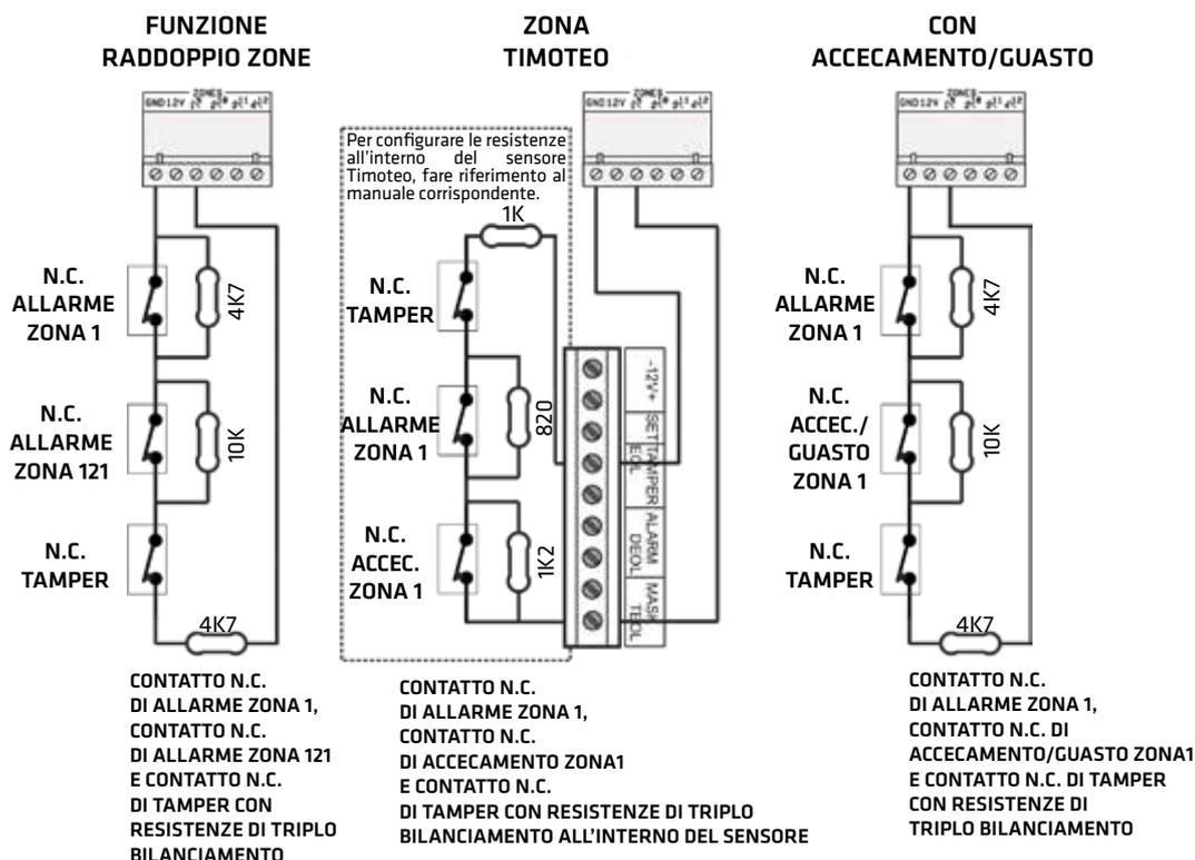
Nella configurazione per raddoppio zone e triplo bilanciamento con guasto/acceccamento, è possibile utilizzare, oltre alle resistenze di bilanciamento standard previste dalla centrale, quelle previste dalle centrali Combivox serie 2012 (vedi esempio per Zona Timoteo).
