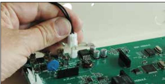
Collegare i faston del cavetto in dotazione sui morsetti C e NC dello switch di tamper (il tamper di centrale è programmato di fabbrica come NA) e il connettore sulla scheda centrale in corrispondenza del morsetto TAMPER.
