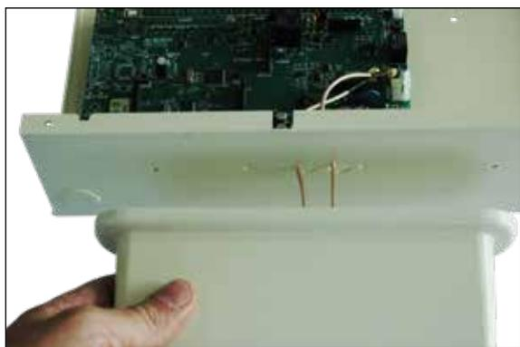
a. Il modulo 4G è dotato di antenna diversity antisabotaggio con due distinti cavi di connessione con terminazione di tipo SMA. Inserire i due cavi che fuoriescono dall'antenna nei due fori predisposti sul contenitore.
