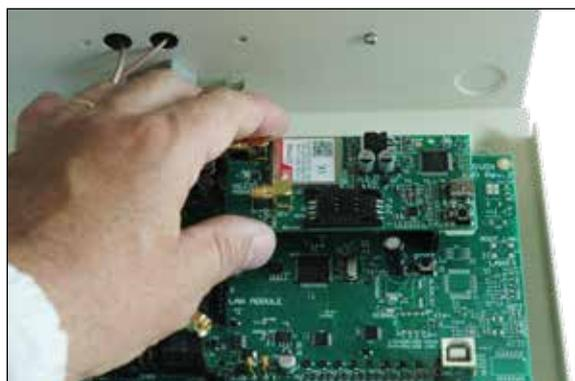
c. Inserire il modulo 4G plug & play su entrambi i connettori GSM MODULE nel verso indicato in figura. Utilizzare i distanziali in nylon, forniti in dotazione, per fissare il modulo alla scheda di centrale attraverso gli appositi fori predisposti su entrambi.
