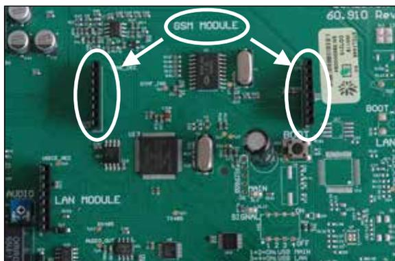
Inserire il modulo cellulare plug & play opzionale (modulo 2G cod. 11.924 o modulo 4G cod. 11.925) sui due connettori GSM MODULE evidenziati in figura, facendo attenzione a rispettarne il verso.
